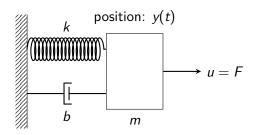
$$x(t) = egin{bmatrix} ext{mass position} \ ext{$v(t)$} \ ext{$v(t)$} \ ext{mass velocity} \end{bmatrix} \in \mathbb{R}^2$$
