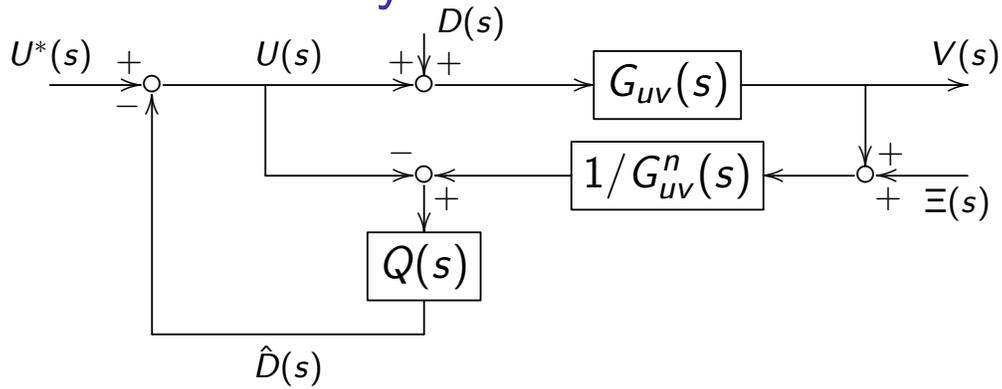
$$G_{uv}^o = \frac{G_{uv} G_{uv}^n}{G_{uv}^n + (G_{uv} - G_{uv}^n) Q}, \quad G_{dv}^o = \frac{G_{uv} G_{uv}^n (1 - Q)}{G_{uv}^n + (G_{uv} - G_{uv}^n) Q}, \quad G_{\xi v}^o = -\frac{G_{uv} Q}{G_{uv}^n + (G_{uv} - G_{uv}^n) Q}$$
