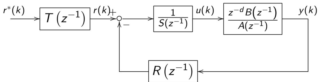
$$\frac{Y(z^{-1})}{R(z^{-1})} = \frac{z^{-d}B(z^{-1})}{A(z^{-1})S(z^{-1}) + z^{-d}B(z^{-1})R(z^{-1})} = \frac{z^{-d}B(z^{-1})}{D(z^{-1})}$$
