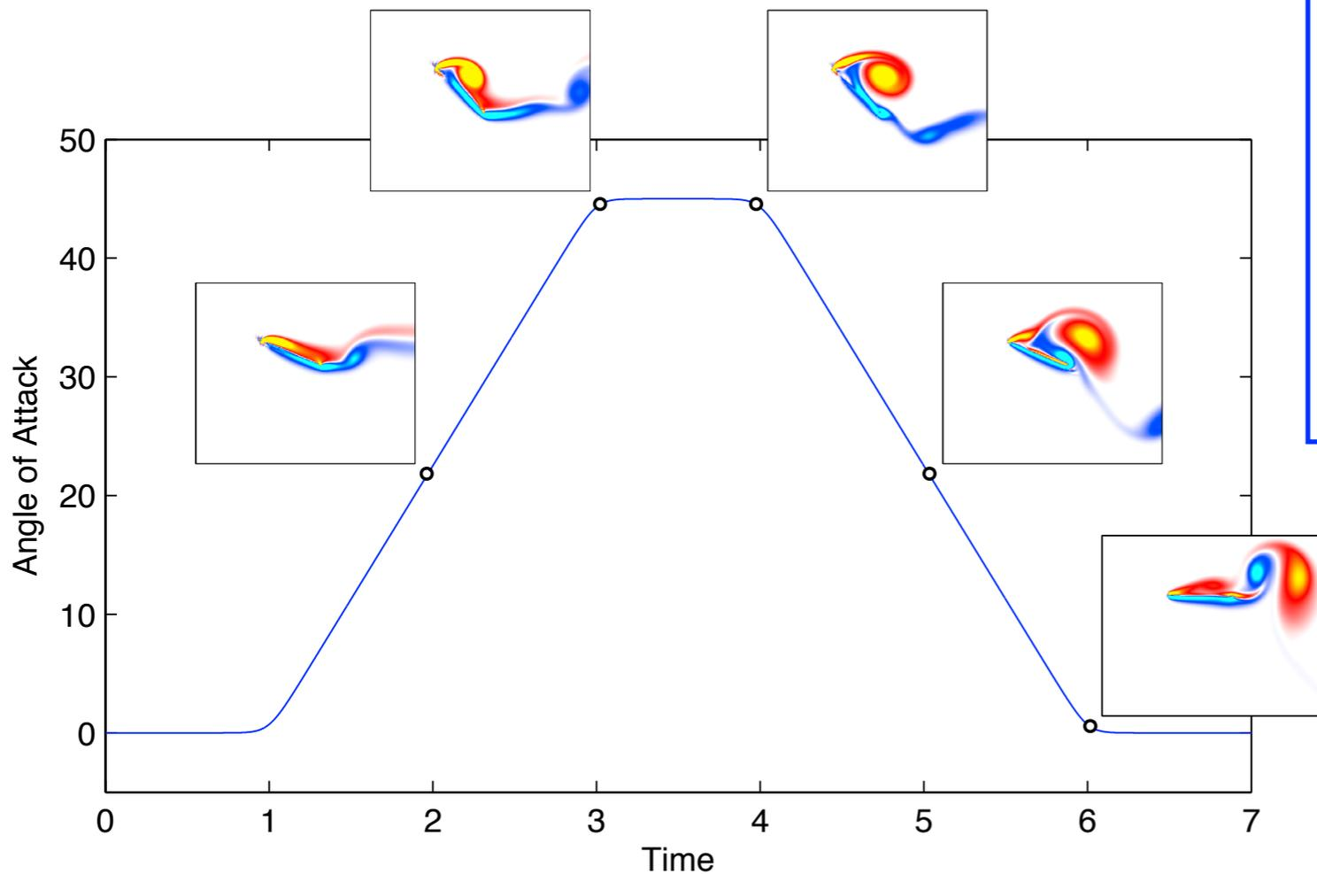
$$\begin{bmatrix} \mathbf{x} \\ \alpha \\ \dot{\alpha} \end{bmatrix}_{k+1} = \begin{bmatrix} A_{\text{ERA}} & 0 & 0 \\ 0 & 1 & \Delta t \\ 0 & 0 & 1 \end{bmatrix} \begin{bmatrix} \mathbf{x} \\ \alpha \\ \dot{\alpha} \end{bmatrix}_k + \begin{bmatrix} B_{\text{ERA}} \\ 0 \\ \Delta t \end{bmatrix} \ddot{\alpha}_k$$
