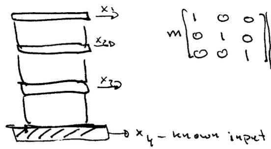
$$m \begin{bmatrix} 1 & 0 & 0 \\ 0 & 1 & 0 \\ 0 & 0 & 1 \end{bmatrix} \begin{bmatrix} \ddot{x}_1 \\ \ddot{x}_2 \\ \ddot{x}_3 \end{bmatrix} + k \begin{bmatrix} 1 & -1 & 0 \\ -1 & 3 & -2 \\ 0 & -2 & 5 \end{bmatrix} \begin{bmatrix} x_1 \\ x_2 \\ x_3 \end{bmatrix} = \begin{bmatrix} 0 \\ 0 \\ 3k \cdot x_4 \end{bmatrix}$$
